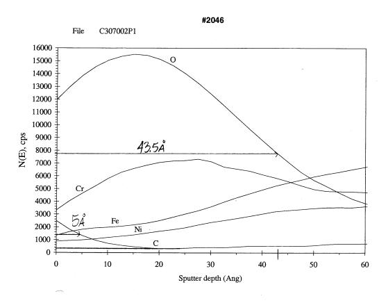
Fig5. AES på ett av Calamo elektropolerat rör av 316L med tjockleken på oxidskiktet 43,5Å.
